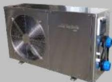
SKS Wärmepumpe HKR Edelstahl zur Außenaufstellung als Luft-Wasser Wärmepumpe. Typ SKS 130 R dBA in 10 m 38 dBA. Heizleistung 13 kW. Leistungsaufnahme 2,5 kW.
